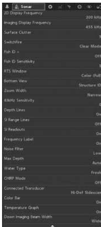
Главное меню: закладка Сонара (режим пользователя установлен на Продвинутый)
