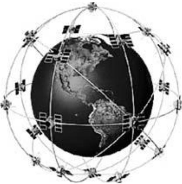
GPS использует систему 24 спутников, которые постоянно посылают информацию на Землю. Ваше местоположение определяется сигналами с 16 спутников и измерением дистанции от спутников.
